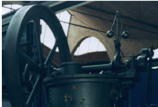
Figura 1.3: Máquina de vapor con un regulador centrífugo o de bola flotante, que aparece en la parte derecha de la imagen.
